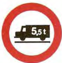
R-107 Entrada prohibida a vehículos de transporte de mercancías con mayor peso que el indicado
