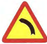
TP-13b Curva peligrosa hacia la izquierda
