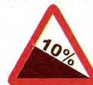
P-16a Bajada peligrosa
