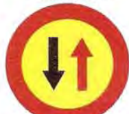
TR-5 Prioridad al sentido contrario
